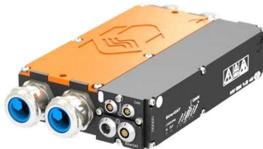
Das HV BM 1.2+U gibt die Messdaten mit einer maximalen Datenrate von bis zu 1MHz über Ethernet und simultan mit einer Datenrate von bis zu 10 kHz über die zusätzliche CAN-Schnittstelle aus. Mit der Option Calc. können daneben Wirk-,
