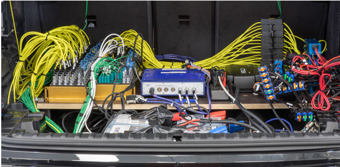
Abb. 3: Der Großteil des Messaufbaus wurde im Kofferraum des SUV eingebaut: Neben den Shunts unter anderem die AD- und Thermomodule sowie das CAN-Interface. (AVL List GmbH)
