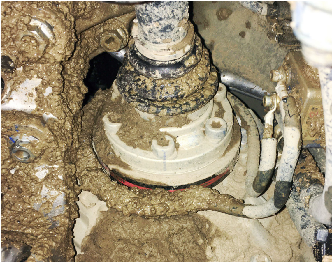
Abb. 4: Neben auf der Achse installierten Sensoren bietet AXON auch Drehmomentmessflansche für die Erfassung wirkender Kräfte an. Die gesamte Messtechnik ist dabei auch für raue Umgebungsbedingungen geeignet, wie Fahrversuche im Gelände. (Foto: AXON Systems GmbH)
