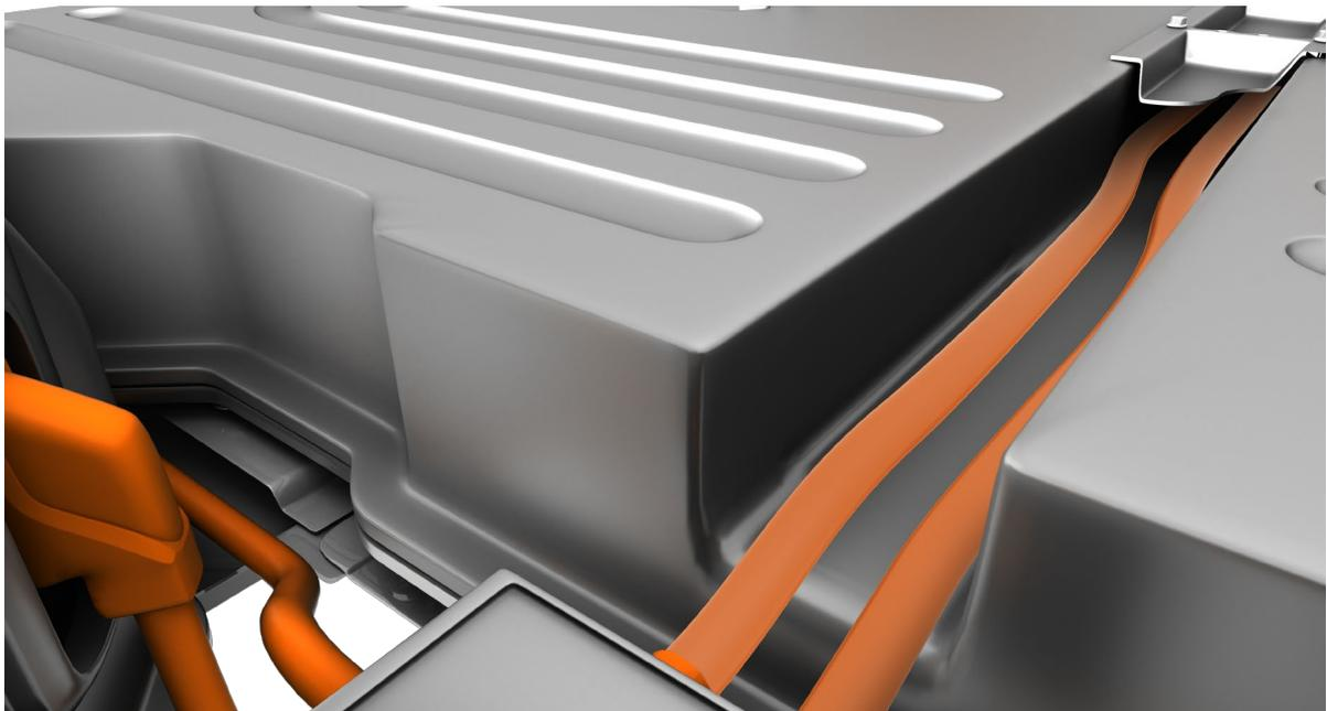
Abb. 2: Enge Kabelschächte bieten nur geringen Bauraum für die Messtechnik, um Strom und Spannung in den HV-Leitungen zu messen.
