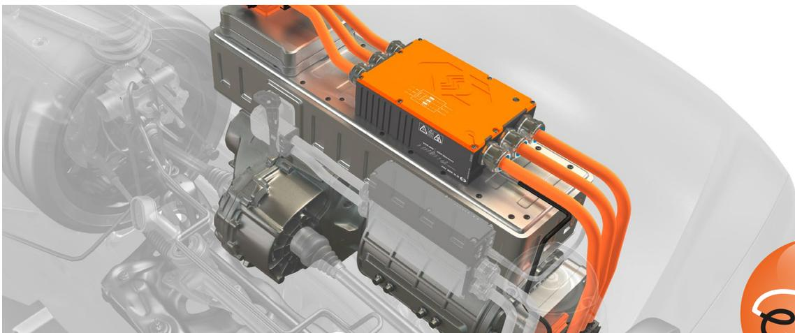
Abb. 1: Mit HV Breakout-Modulen lassen sich im Fahrzeug-Bordnetz sehr präzise und sicher Ströme, Spannungen und Leistungen messen. Vorausgesetzt, es ist ausreichend Bauraum verfügbar.
