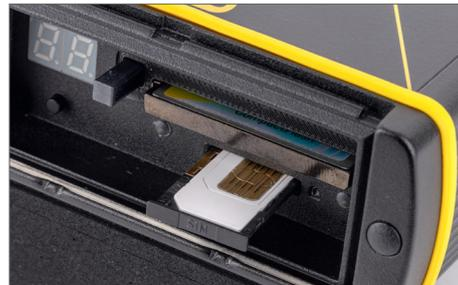
Abb. 3-6: SIM-Karte mit Kartenhalter einsetzen
