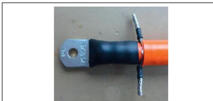
Abb. 5-42: HV BM 1.2+S, Leitung HV+, Abschirmgeflechtstränge verdrillt, isoliert und verzinkt
