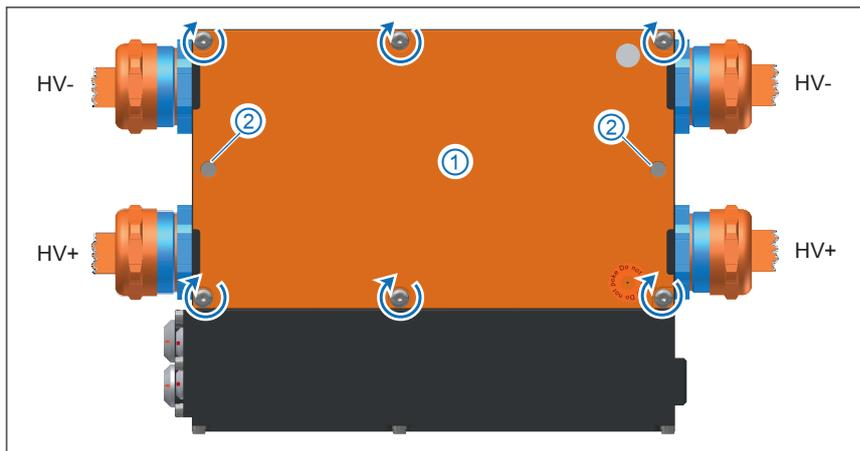
Abb. 5-44: HV BM 1.2+S, HV-Leitungen montiert, Gehäuse geschlossen
