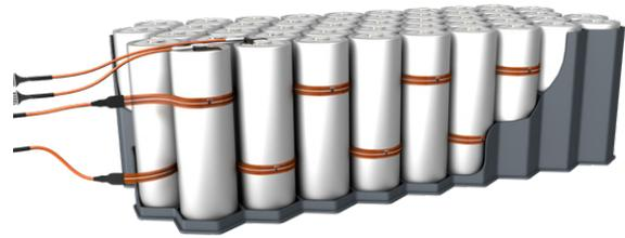
Abb. 9: Flexprint-Trägerfolien als Streifen für die Temperaturmessung zwischen Rundzellen.
