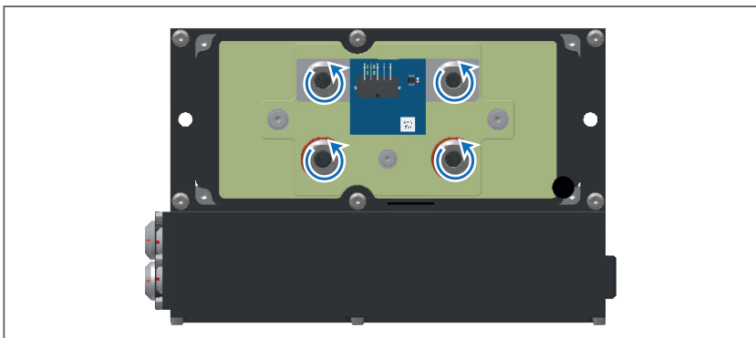
Abb. 5-3: HV BM 1.2, Gehäuse offen, M8-Muttern lösen und abschrauben
