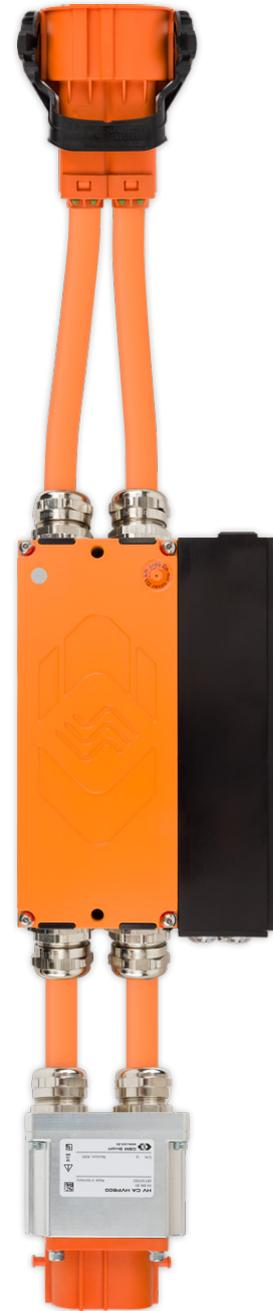
Abb. 4: CSM HV Breakout-Modul mit angeschlossenen Leitungen sowie Stecker und Buchse als fertig vorbereitetes, HV-sicheres Stecksystem. Das HV BM-System von CSM erlaubt die verteilte Messung und Echtzeit-Analyse von hohen Strömen, Spannungen und Leistungen in den HV-Leitungen während der Fahrt mit einer Abtastrate von bis zu 1MHz/Signal.
