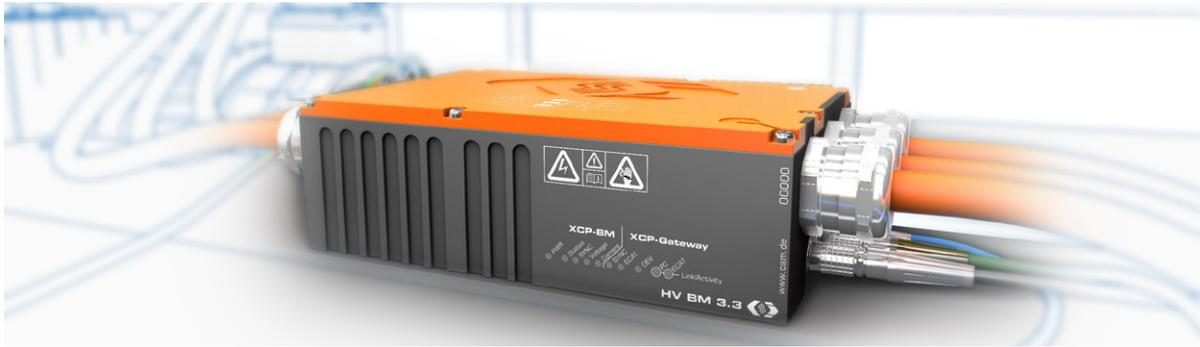
Abb. 7: HV Breakout-Modul 3.3.: Über eine EtherCAT- und CAN-Schnittstelle kann das Messsystem mit weiteren Messmodulen erweitert werden. Über eine Gbit-Ethernet-Schnittstelle werden die Daten an den Messrechner gesendet. Über die Kabelverschraubungen werden (geschirmte) HV-Leitungen bis 95 mm<sup>2</sup> innerhalb des Gehäuses angeschlossen.
