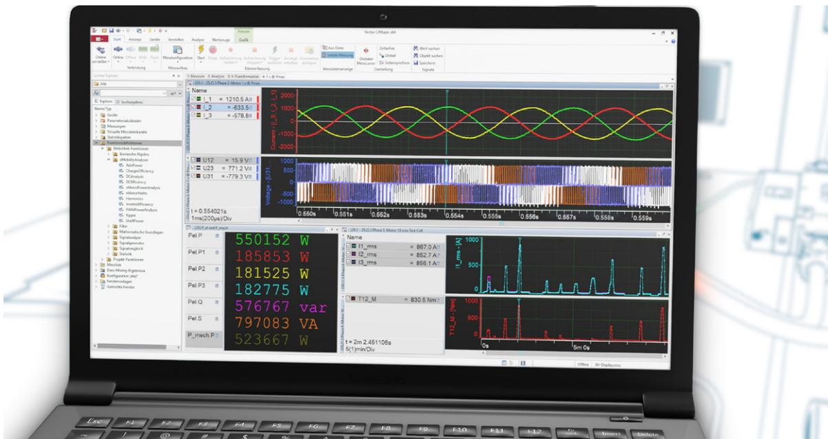
Abb. 5: Leistungsanalyse eines zehnjährigen Testlaufs am Prüfstand mit CANape. Die Rohwerte der Außenleiterspannungen und Strangströme sind im oberen Bereich dargestellt. Die dabei berechneten elektrischen Größen wie Wirk-, Blind- und Scheinleistung und die berechnete mechanische Leistung sind unten links numerisch aufgeführt. Rechts unten die drei berechneten Effektivwerte der Motorströme.
