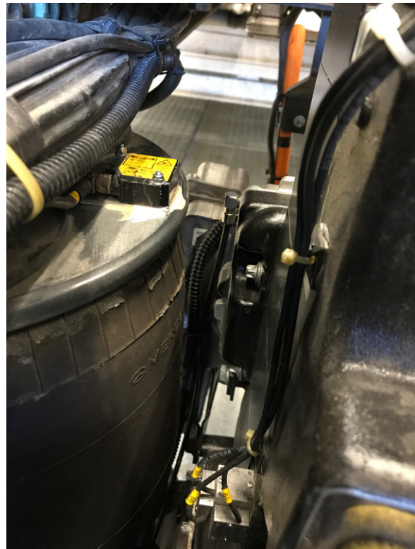
Abb. 4: Mit Lasern wird geprüft, ob es zu Kollisionen zwischen Luftfederbälgen und dem Gussgehäuse der E-Achse kommen kann.
