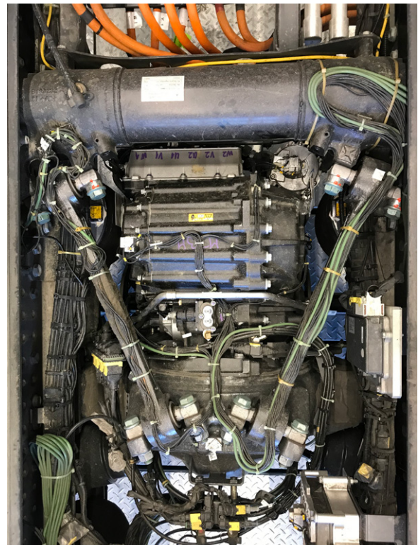
Abb. 2: E-Achse mit den Elektromotoren; links und rechts davon die Luftfederbälge unter dem Rahmenlängsträger.
