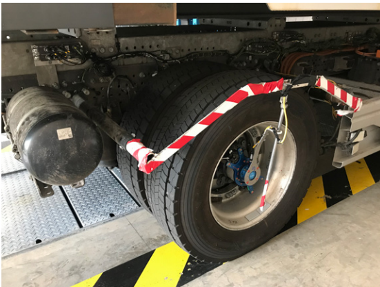
Abb. 6: RoaDyn Messrad an der E-Achse zum Messen der dreidimensionalen Radkräfte ( F_x , F_y , F_z ) von \pm 180 kN und Drehmomente ( M_x , M_y , M_z ) von \pm 50 kNm.
