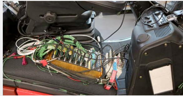
Abb. 4: Mit Montagekomponenten werden die Messmodule kompakt zusammengefügt und mit der Trägerplatte verbaut.
