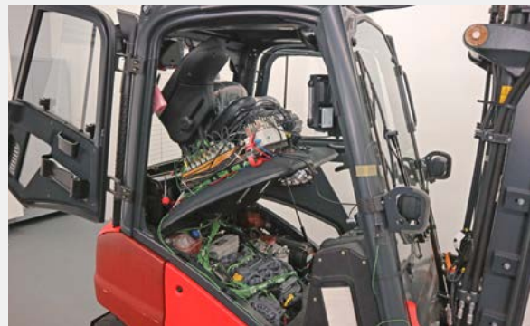
Abb. 5: Durch die geringe Größe lässt sich die Messtechnik auch bei geringem Platzangebot in der Kabine unterbringen.
