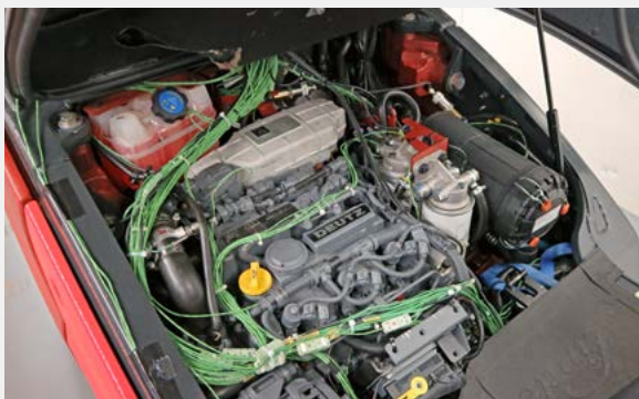
Abb. 2: Die Temperatur- und Drucksensoren werden an den vorgegebenen Stellen im Motorraum angebracht.
