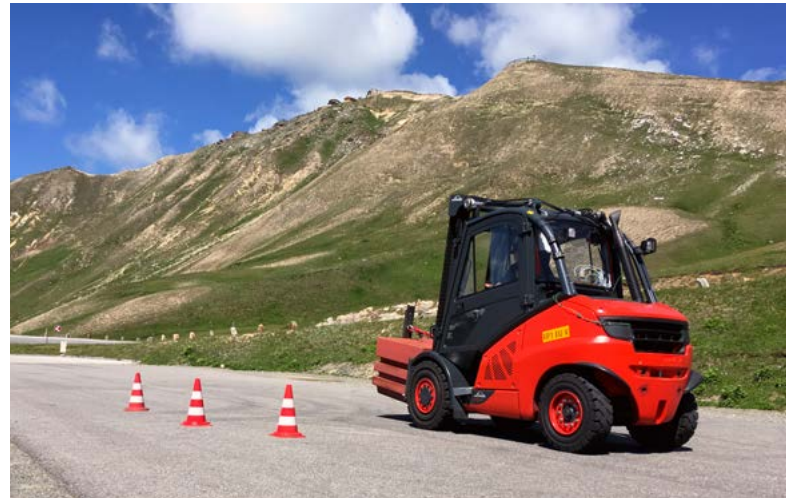
Abb. 1: In der Höhererprobung wird ein Gabelstapler auf 2.400 m in den Alpen erprobt. Nach der Motorintegration muss das Fahrzeug weiterhin einwandfrei funktionieren.
