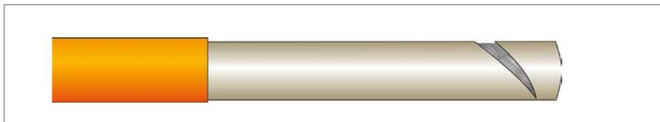
Abb. 7-13: Schritt 2: Schutzfolie entfernen
