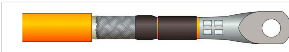
Abb. 7-10: Schritt 7: Schrumpfschlauch aufziehen und Kabelschuh aufstecken
