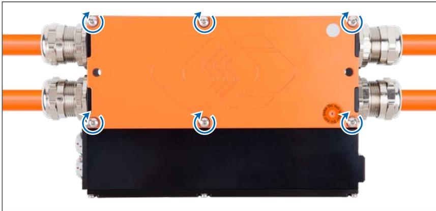
Abb. 4-21: HV BM 1.2, Gehäuse geschlossen und HV-Leitung montiert
