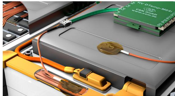
Abb. 4: Einzelsensor einer IC-Sensorbaugruppe auf einem Modulgehäuse für die Erfassung des Temperaturverlaufs.
