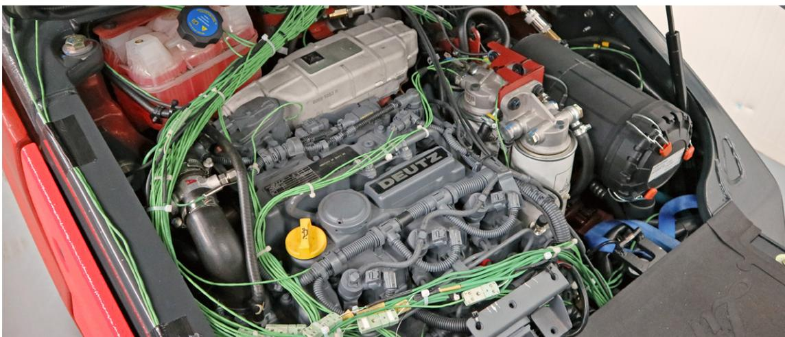
Abb. 3: Die Temperatur- und Drucksensoren werden an den vorgegebenen Stellen im Motorraum angebracht.
