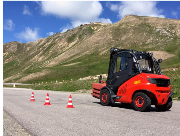
Abb. 1: In der Höhererprobung wird ein Gabelstapler auf 2.400 m in den Alpen erprobt. Nach der Motorintegration muss das Fahrzeug weiterhin einwandfrei funktionieren.
