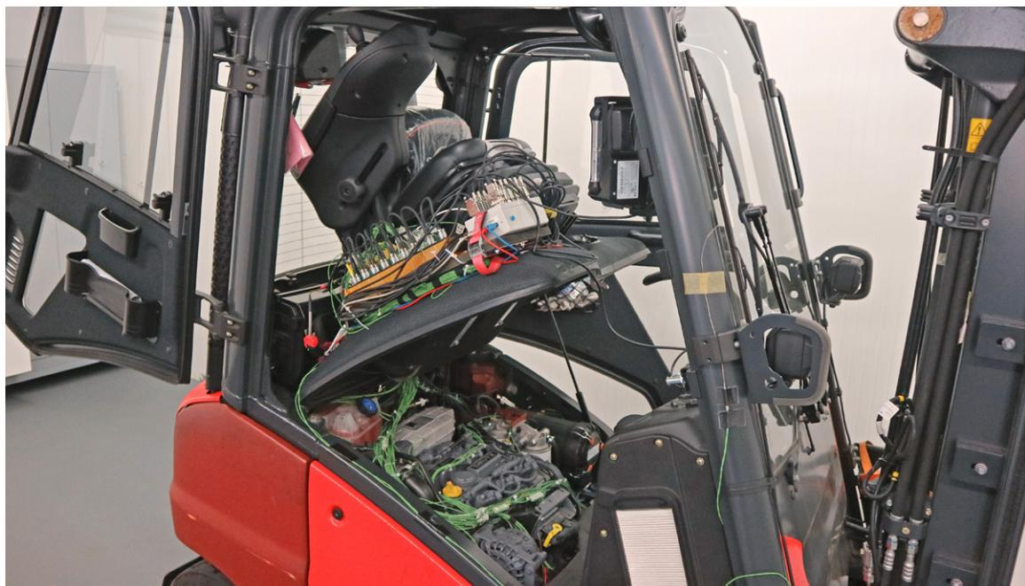
Abb. 5: Durch die geringe Größe lässt sich die Messtechnik auch bei geringem Platzangebot in der Kabine unterbringen.
