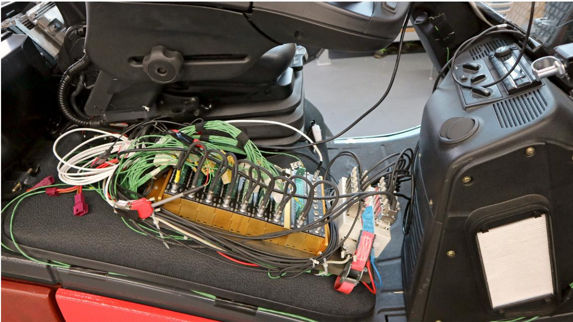
Abb. 4: Mit Montagekomponenten werden die Messmodule kompakt zusammengefügt und mit der Trägerplatte verbaut.
